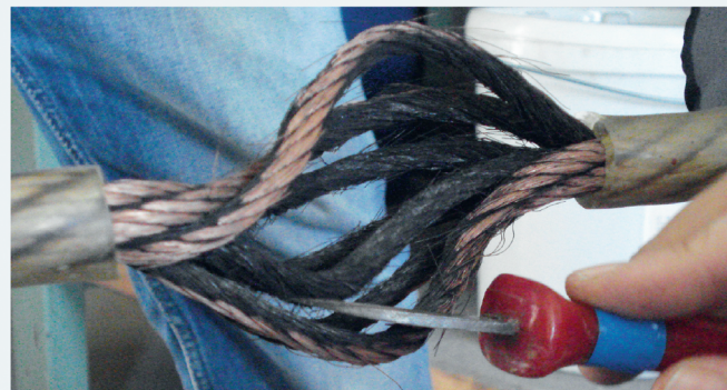
Bild 6 (links): Mit dem Verfahren erkannter Fehler im Leiterseil
